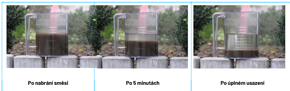
Obrázek 12: Kontrola množství kalu v aktivaci
